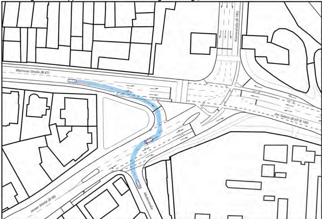
Abbildung 18: Schleppkurve für das Bemessungsfahrzeug „Pkw“
