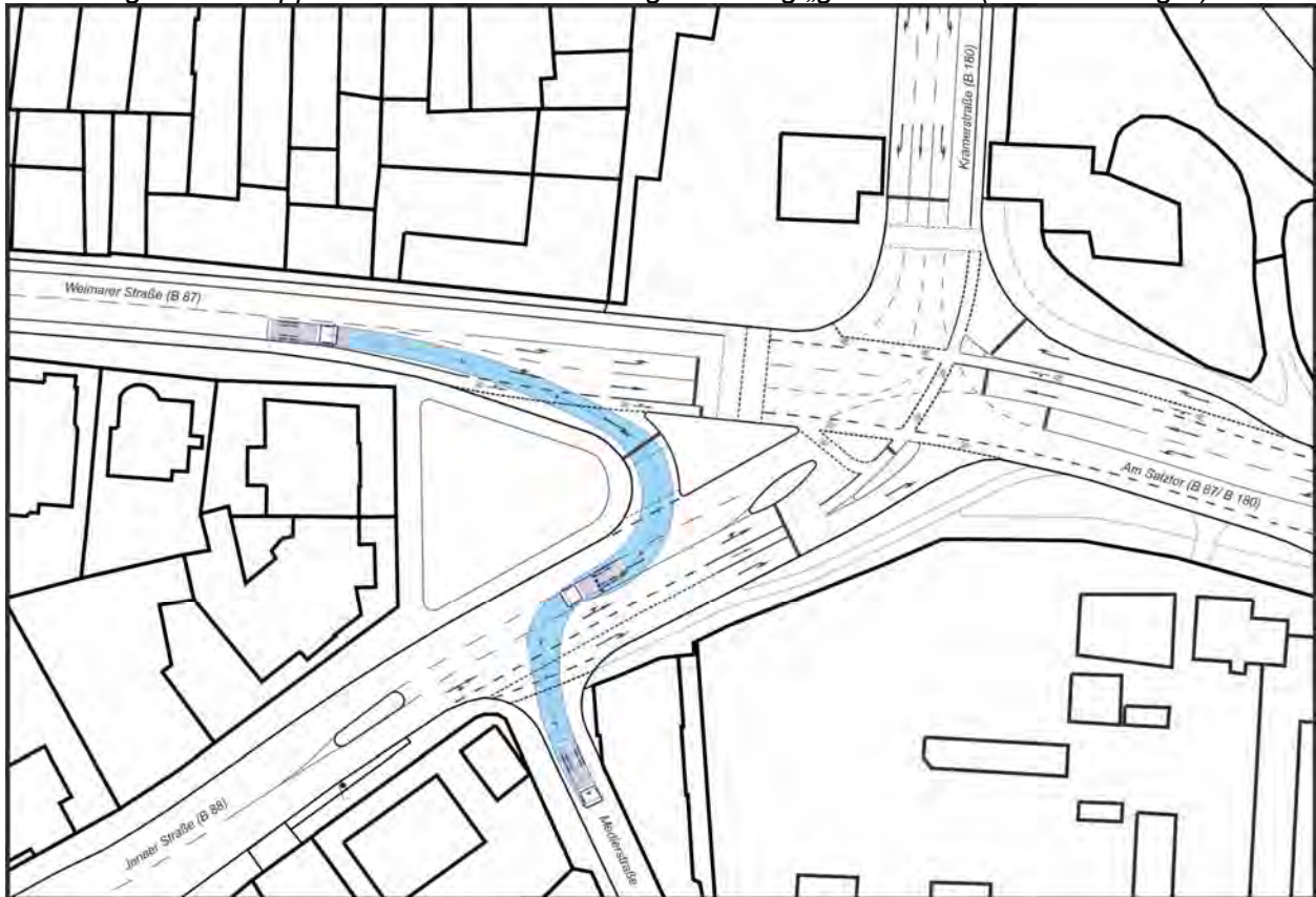
Abbildung 19: Schleppkurve für das Bemessungsfahrzeug „großer Lkw (ohne Anhänger)“
