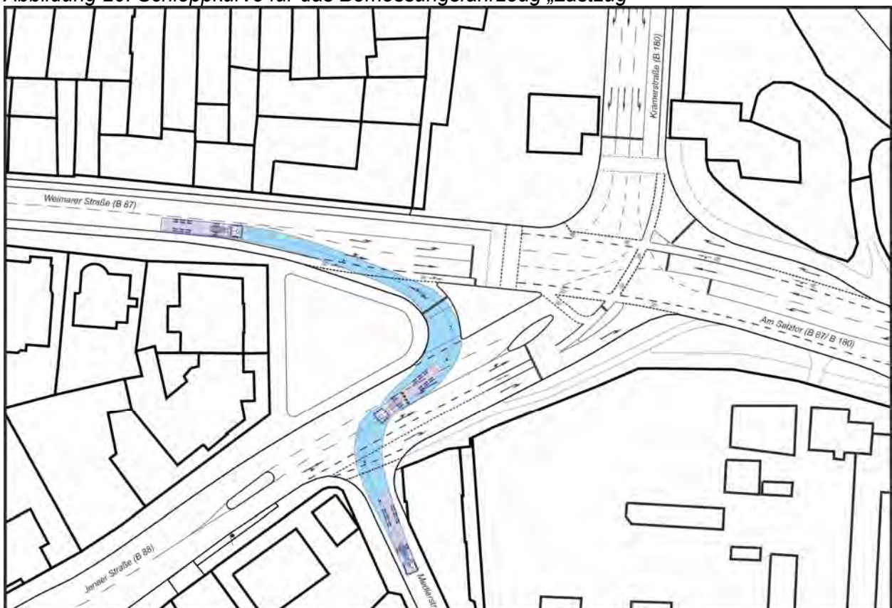
Abbildung 20: Schleppkurve für das Bemessungsfahrzeug „Lastzug“
