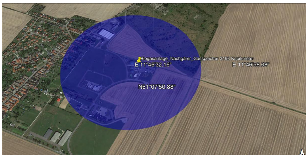
Abbildung 5: Gefahrenzone Biogasanlage (Quelle: Karte 3: Auswirkungsbetrachtung agriwatt GmbH Flemmingen – Biogasanlage, SW Ingenieurbüro Brandschutz GmbH, 29.10.2018)
