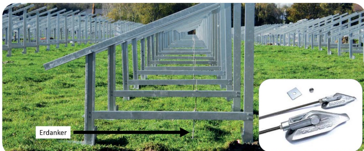
Abbildung 5-47: Erdanker - System von Platipus zur Verbindung Kollektortische und Erdreich
